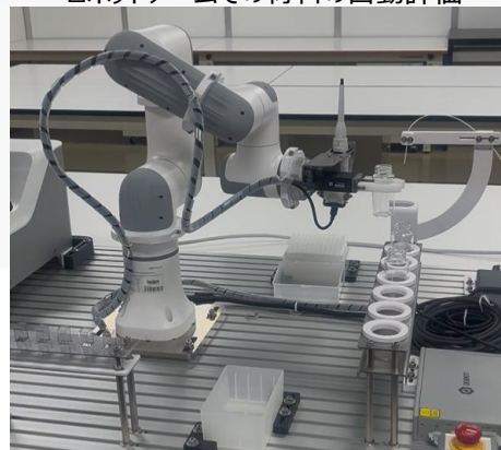
ロボットアームでの材料の自動評価
